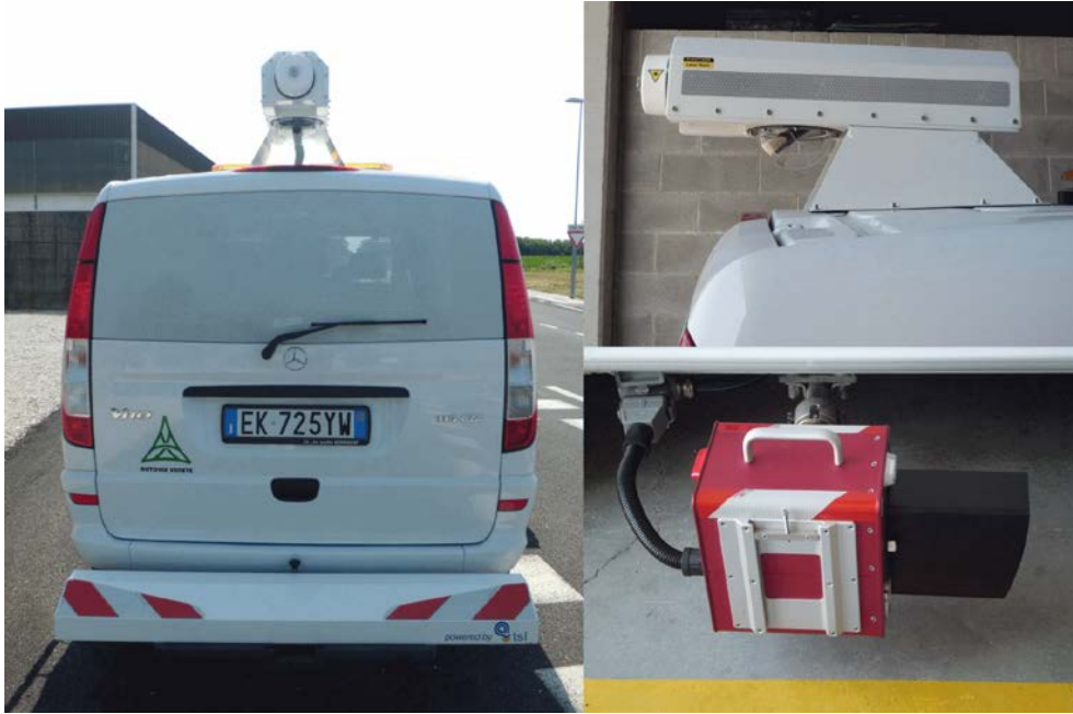
Particolari del Profilometro Laser per misure di regolarità della pavimentazione, Laser scanner , Retroriflettometro per segnaletica
