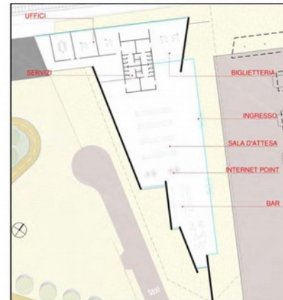
progetto: pianta piano terra autostazione particolare area fermata autobus e pensiline di sosta passeggeri
